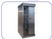
RMS Body Scan: Full-Body scan \alpha , \beta/\gamma con scintillatori o rivelatori proporzionali software e schede ID, Lan
