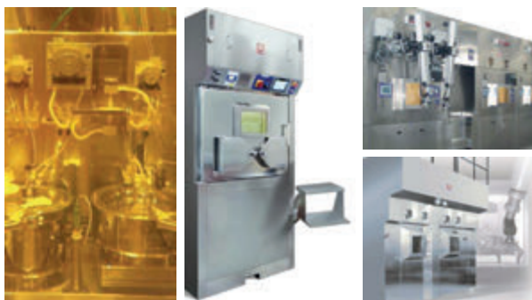
Figura 1. Esempi di celle calde.
