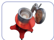
COMO: misura della contaminazione dei materiali e degli alimenti con spettrometria Gamma inopzetto
