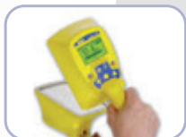
Graetz Como 170: area da 170 cm 2 facile da usare, misura \alpha , \beta/\gamma RS 232, opzionale rivelatore esterno
