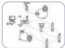
Sistema Tera: monitoraggio e mitigazione del radon, fino a 16 sonde radon in wireless e unità centrale
